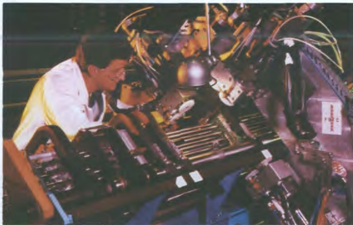
一名技术员正在检查燃料组件的结构。燃料组件在各种工况下的完整性,可用一些尖端的计算机程序模拟。来源:Framatome。
