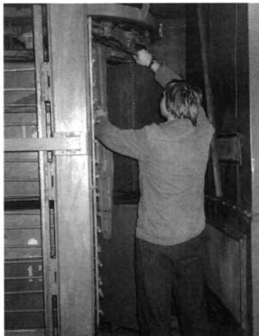
Los sistemas de seguridad deben ser capaces de prevenir accidentes como este, en que un operador trataba de extraer un bulto atascado en una instalación de irradiación con la fuente expuesta.
