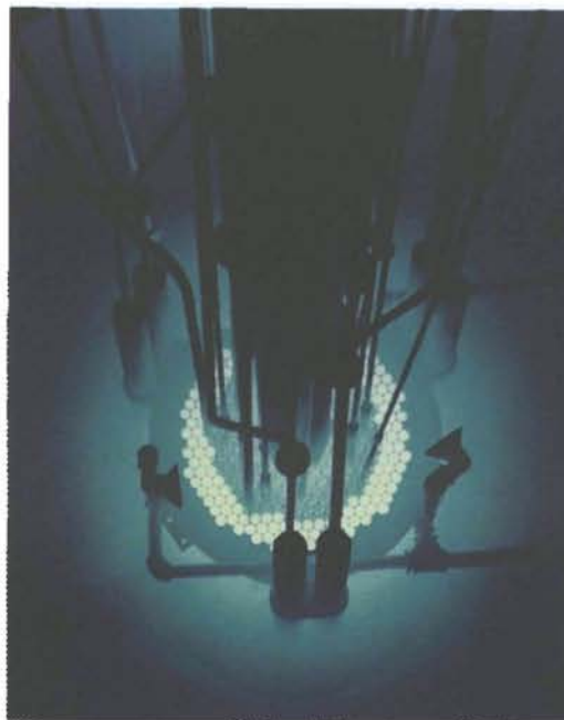
Réacteur de recherche utilisé au Japon pour tester le comportement du combustible dans le cadre d'études sur la sûreté. (Photo: JAERI)
