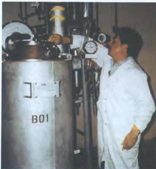
在现场试验中取供实验室分析用擦拭样品。
