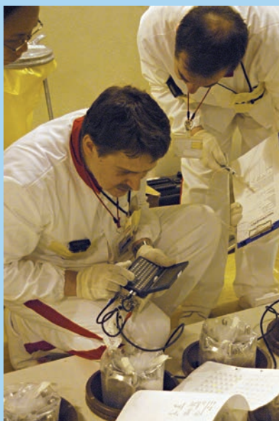
Inspecteurs des garanties de l'AIEA utilisant du matériel spécialisé – un analyseur multicanal miniature (MMCA) – pour vérifier du combustible neuf dans une centrale nucléaire.
