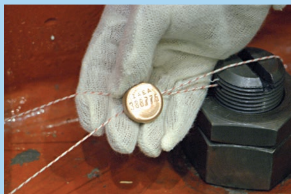
Les scellés à embout métallique (CAPS) sont largement utilisés pour sceller les conteneurs de matières et le matériel des garanties de l'AIEA.
