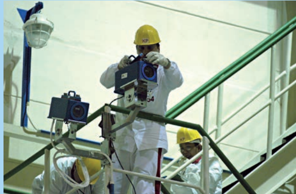
Le système de surveillance numérique à caméra unique ALIS est un système pleinement autonome. Il est généralement installé en hauteur pour donner une vue d'ensemble claire et faciliter l'enregistrement de l'activité dans la salle du réacteur.
