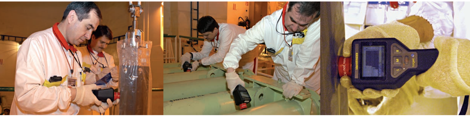
Inspecteurs de l'AIEA utilisant le détecteur portable version 5 (HM-5). Il s'agit d'un appareil numérique portable de spectrométrie gamma combinant diverses fonctions telles que la mesure de débit de dose, l'identification des matières nucléaires et des isotopes (par ex. 235U).
