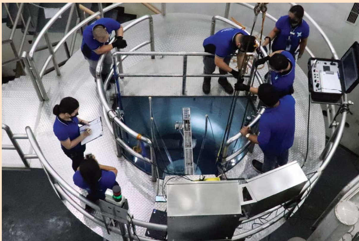
Carga de una barra de combustible en el núcleo del Conjunto Subcrítico con fines de Capacitación, Enseñanza e Investigación (SATER) en Filipinas. (Fotografía cortesía del Instituto Filipino de Investigaciones Nucleares (PNRI))
