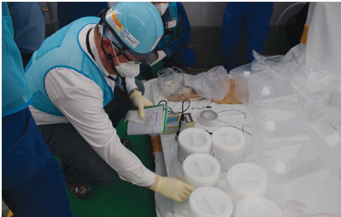
Especialista del Organismo procesa muestras de agua tratada mediante el ALPS obtenidas en la central nuclear de Fukushima Daiichi para su posterior análisis en laboratorios del Organismo y de entidades independientes. (Fotografía por cortesía de TEPCO)
