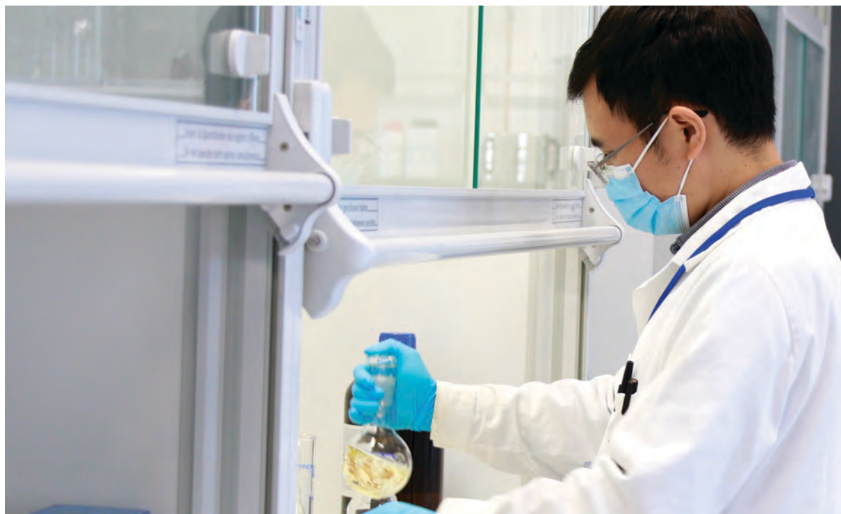
Подготовка образцов для проверки географического происхождения и выявления фальсифицирующих примесей в меде путем измерения соотношения стабильных изотопов водорода ( \delta^2H ) в сахарах меда.
