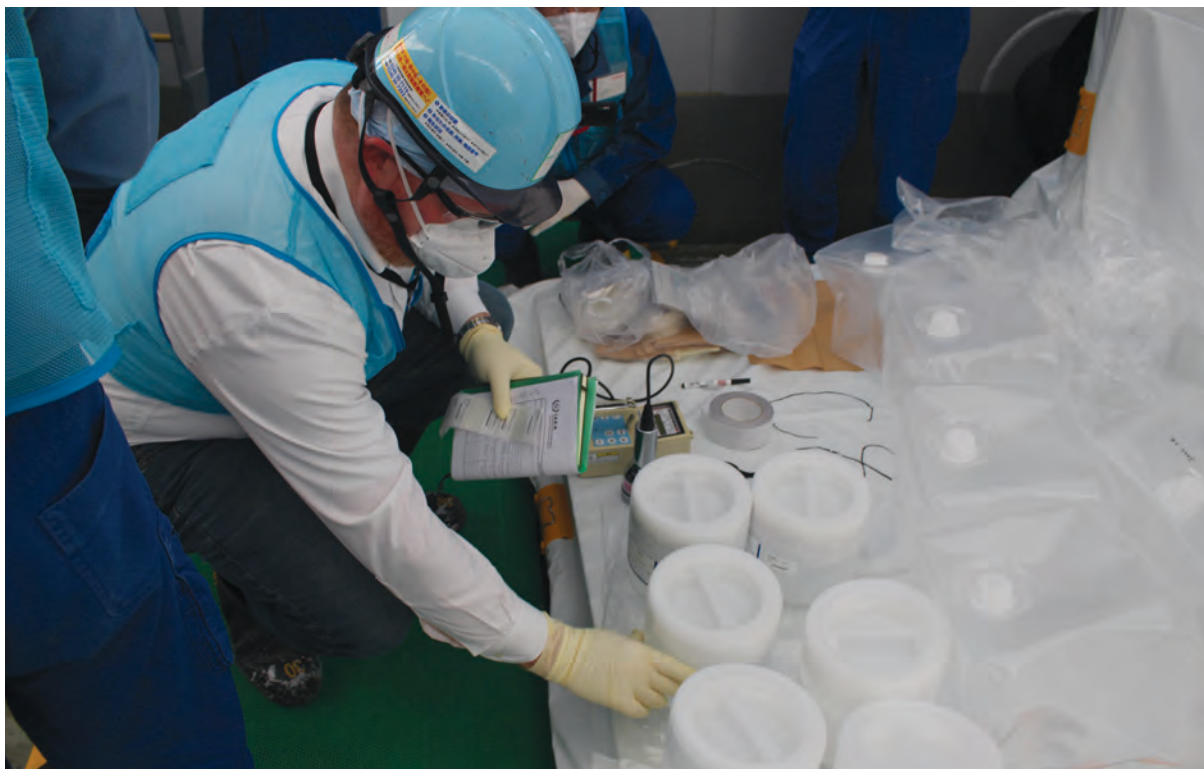
Эксперт Агентства обрабатывает пробы очищенной с помощью ALPS воды, взятые на АЭС «Фукусима Дайити», для дальнейшего анализа в лабораториях Агентства и сторонних лабораториях. (Фотография предоставлена ТЕРКО)
