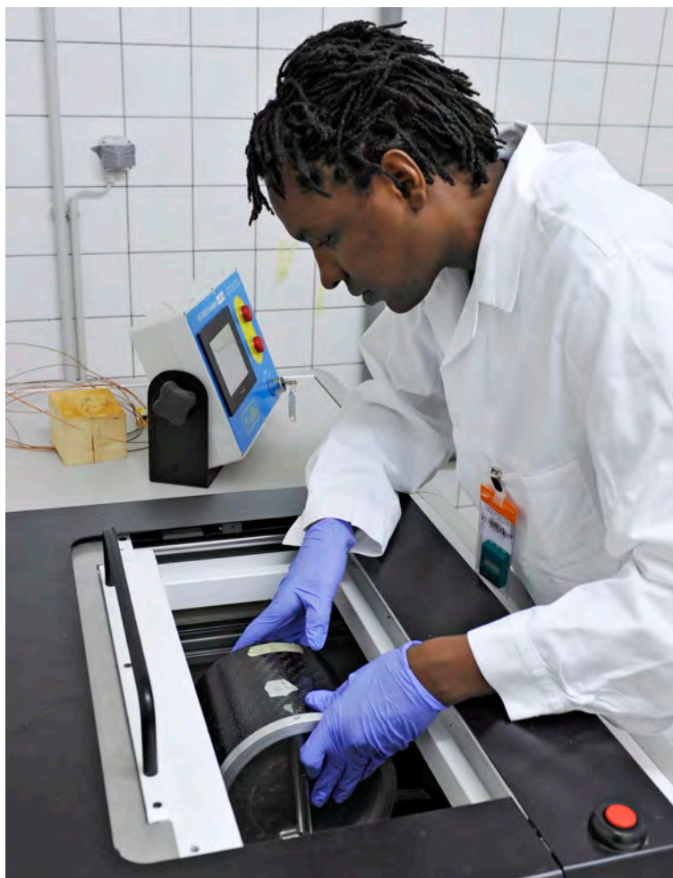
Научный сотрудник Агентства, использует рентгеновский аппарат для облучения крупных организмов малыми дозами.
