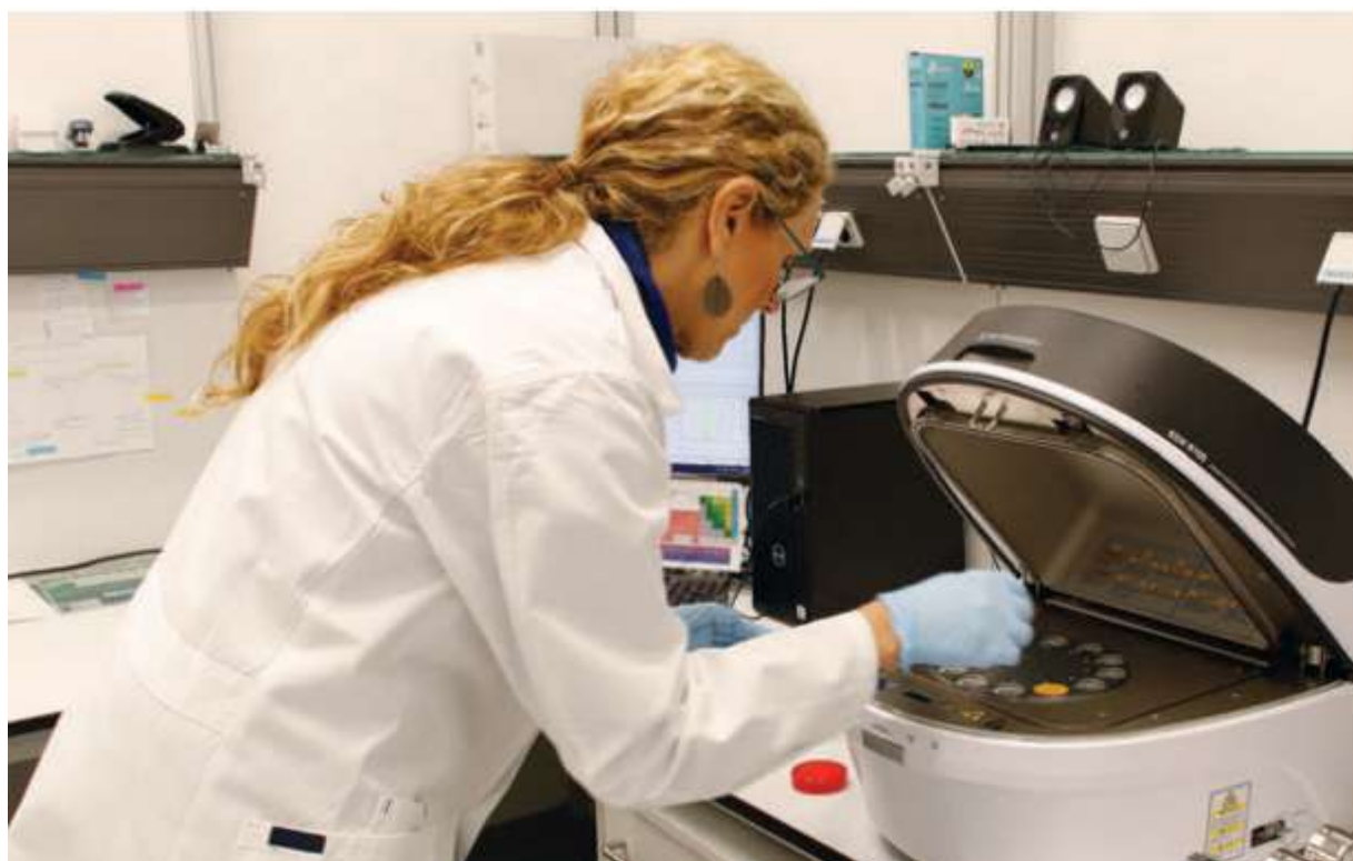
Mise au point d'une méthode permettant de tester la sûreté et la qualité des épices à l'aide de la spectrométrie de fluorescence X à dispersion d'énergie dans les laboratoires du Centre mixte FAO/AIEA à Seibersdorf.
