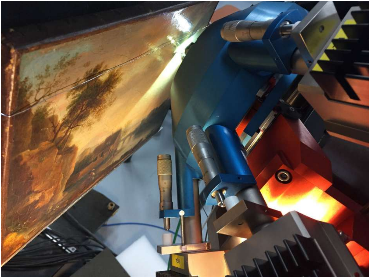
Analyse par faisceaux d'ions d'une peinture sur canevas anonyme et sans titre, probablement de l'École française et datant du XVII e ou XVIII e siècle, dans l'installation AGLAÉ, au Musée du Louvre.
