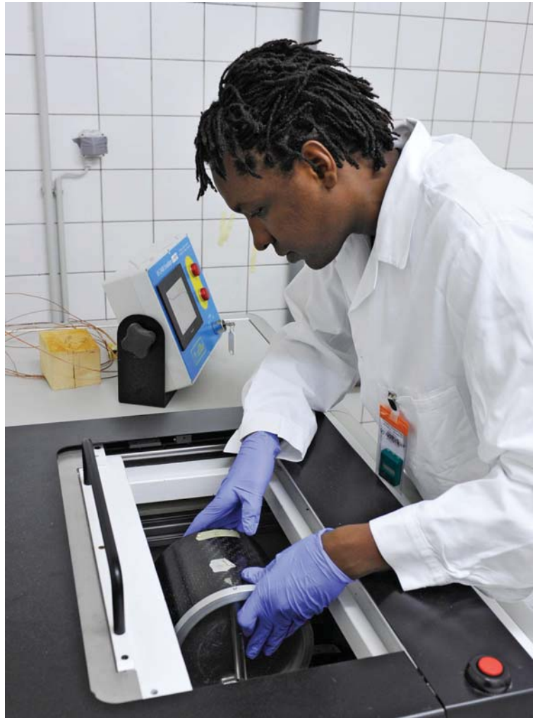
原子能机构研究科学家使用 X 射线机以较低剂量辐照较大生物体。
