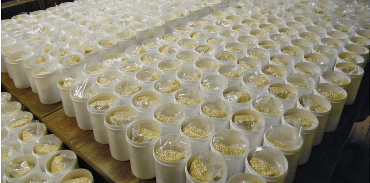
制备按单位数量分装的经认证的基准材料 IAEA-464（糙米中的放射性核素）。
