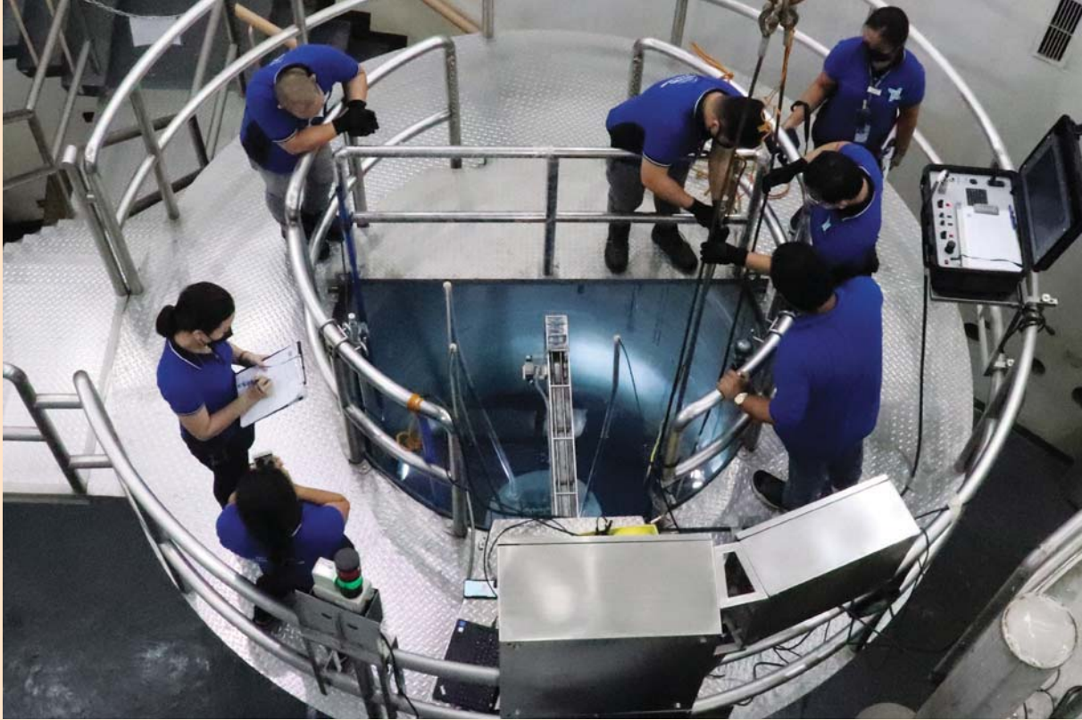
تحميل قضبان الوقود إلى قلب المجمعّة دون الحرجة لأغراض التدريب والتعليم والبحث (المجمعّة SATER) في الفلبين (الصور مهذاة من معهد البحوث النووية الفلبيني)
