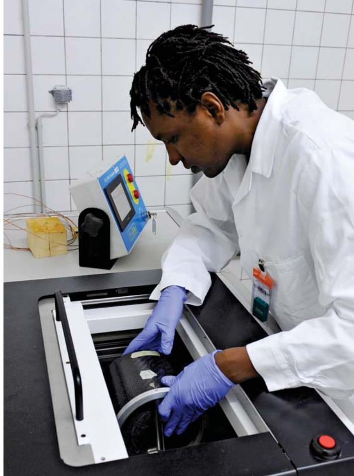
عالم بحوث في الوكالة يستخدم جهاز توليد أشعة سينية لتشعيع كائنات أضخم بجرعات أقل.
