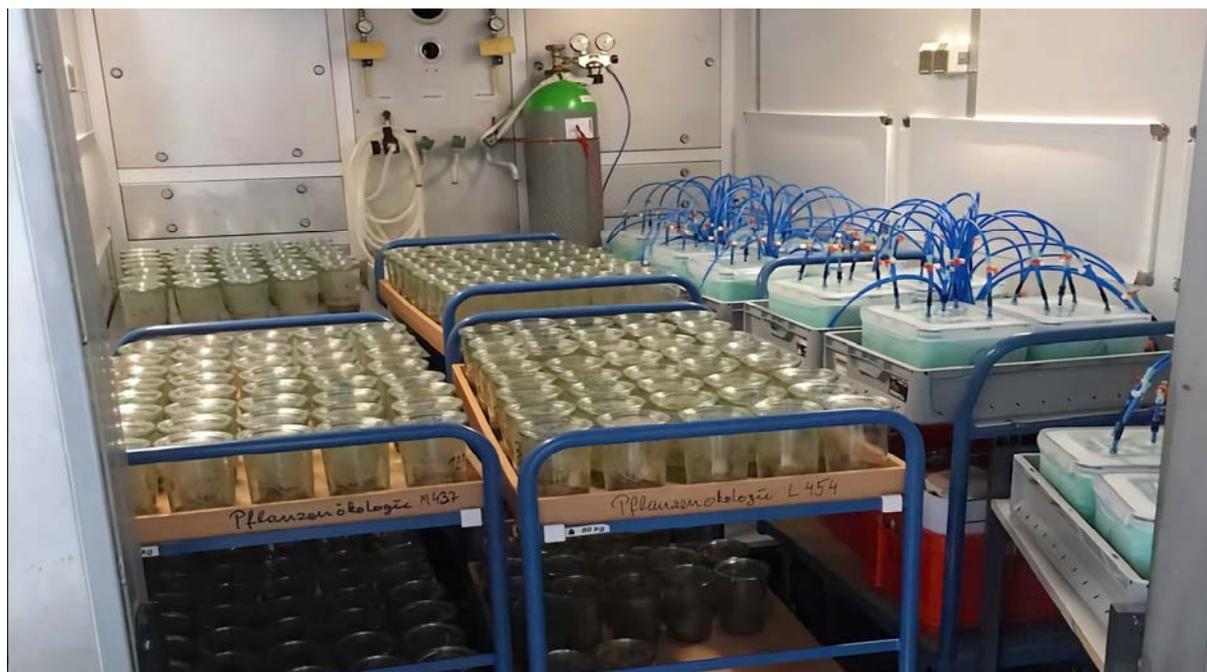
*Рис. 2. Инкубация почвы в климатической камере в почвенной лаборатории
