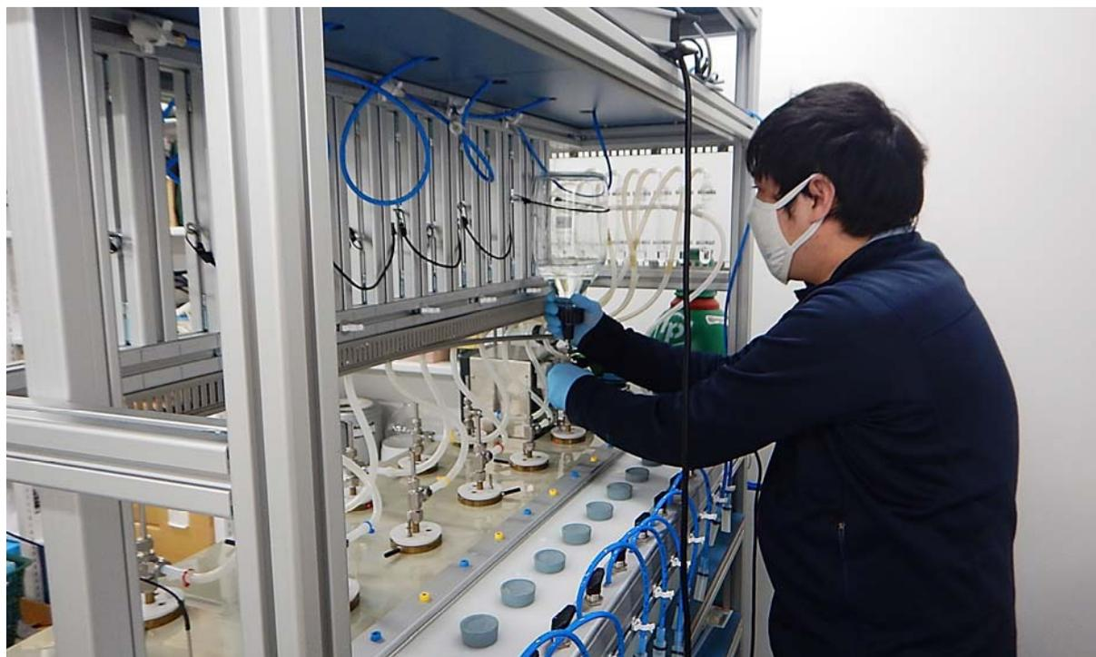
*Рис. 9. Технический персонал префектуры Фукусима, работающий с системой обогащения проб тритием. (Фото предоставлено Центром возрождения окружающей среды префектуры Фукусима.)*
