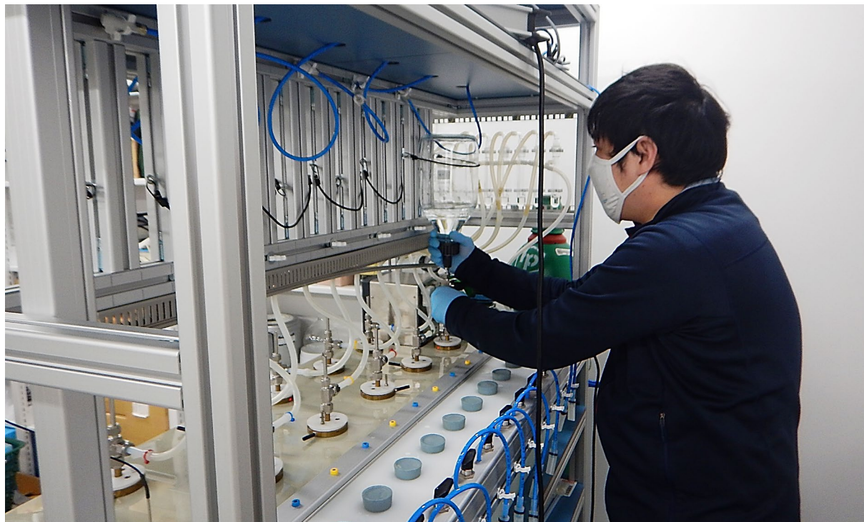
图9. 福岛县技术人员正在氙浓缩系统上工作。(照片由福岛环境创造中心提供。)
