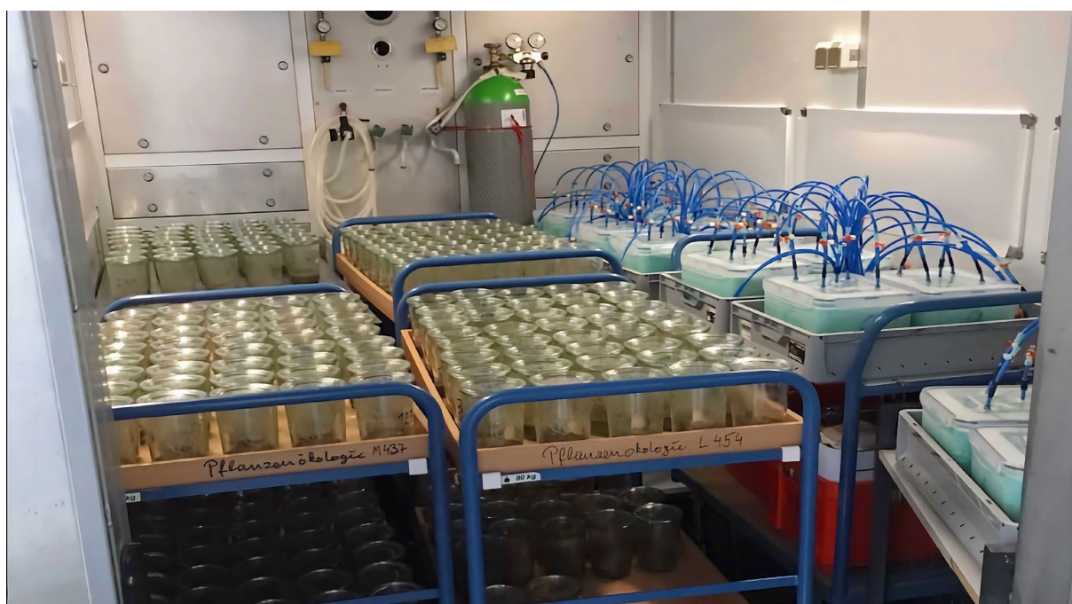
图 2. 在德国吉森尤斯图斯-李比希大学土壤实验室的气候室中进行土壤培养。
