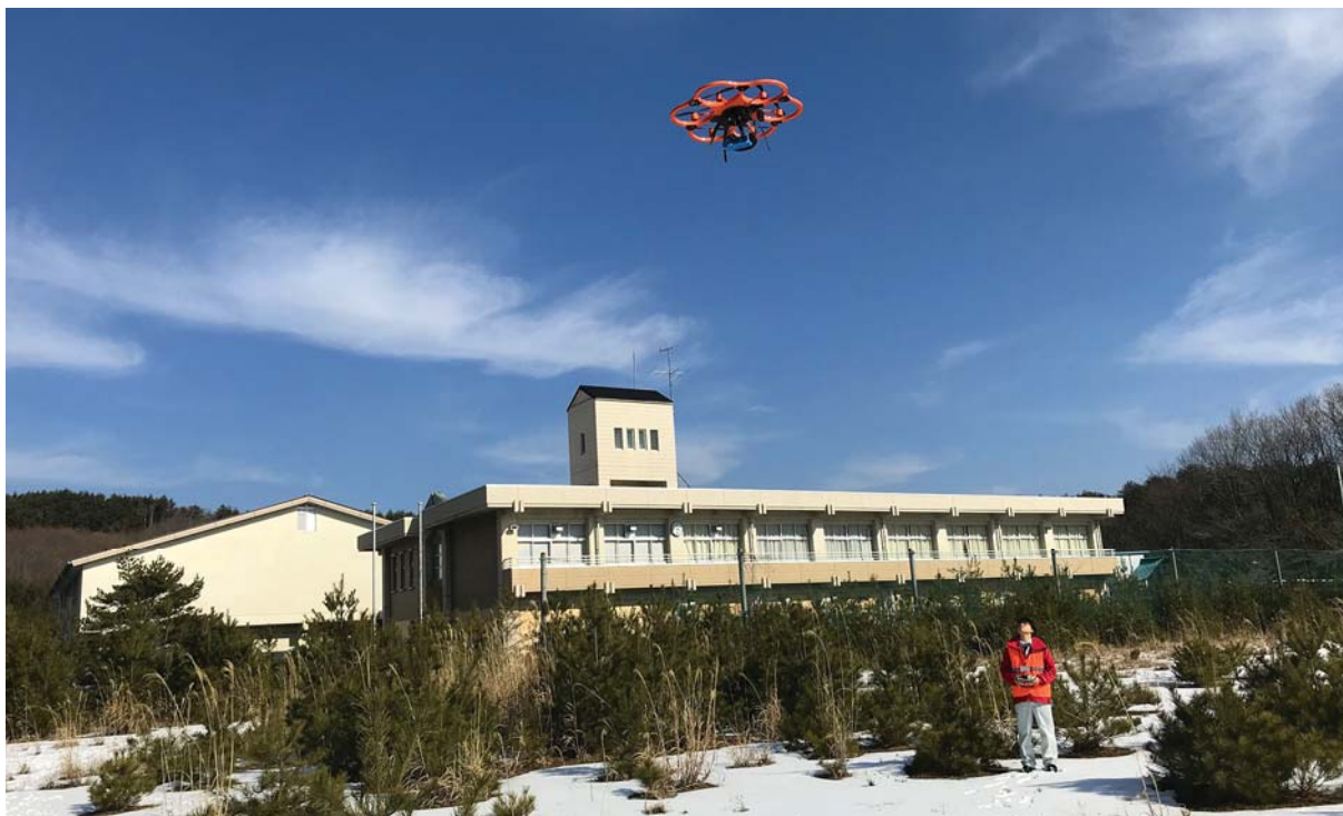
Fig. 3. Una nueva tecnología que utiliza drones, desarrollada por el Organismo para su uso por las autoridades de la prefectura de Fukushima (Japón), permite efectuar mediciones radiológicas. (Fotografía por cortesía de la prefectura de Fukushima.)
