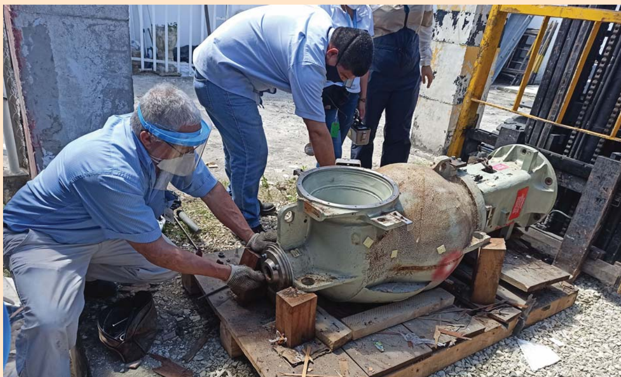
Expertos desmantelan un cabezal de teleterapia utilizado para la atención oncológica en Colombia en el marco de los preparativos para su almacenamiento en condiciones de seguridad tecnológica y física.
