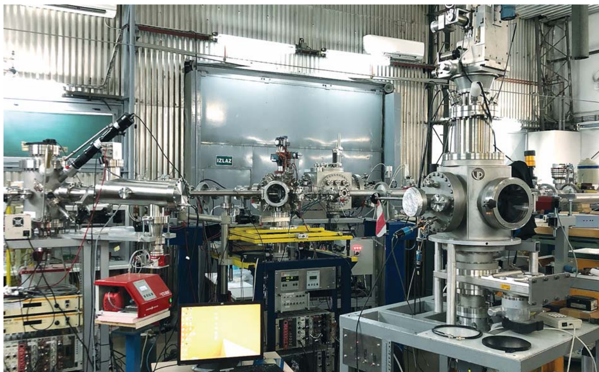
Fig. 2. La instalación de fuente de iones de helio y de irradiación de materiales de fusión con doble haz, establecida con apoyo del Organismo en el Instituto Ruđer Bošković de Croacia, garantiza el acceso a experimentos en materia de investigación sobre materiales para la fusión, entre otras esferas de investigación.
