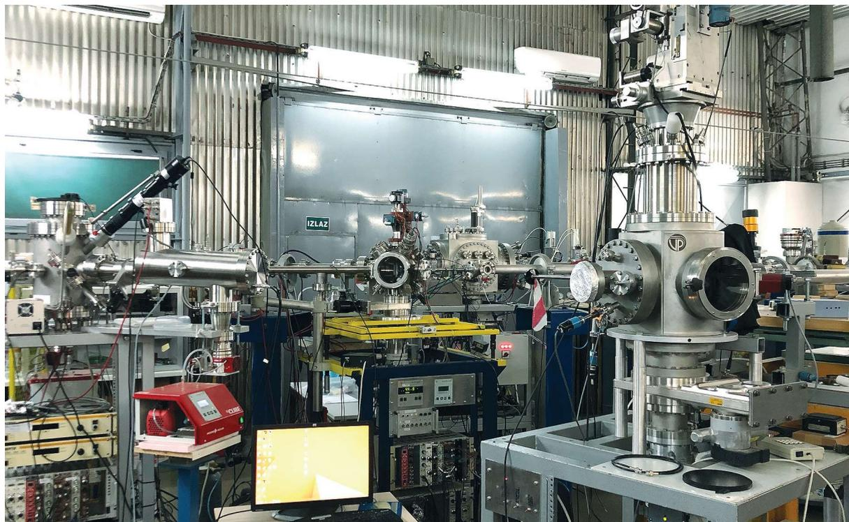
FIG. 2. L'installation « He Ion Source and DiFU Dual-Beam Facility », établie à l'Institut Ruđer Bošković (Croatie) avec le concours de l'Agence, permet de réaliser des expériences sur les matériaux de fusion, entre autres domaines de recherche.
