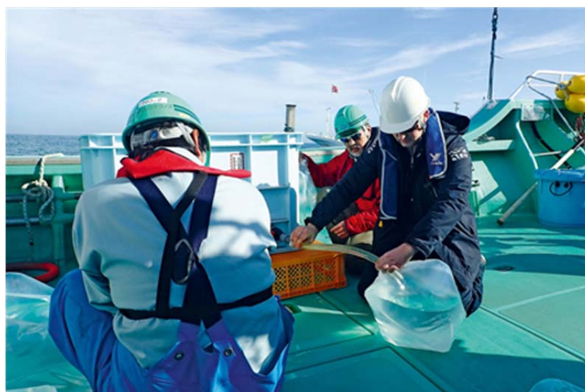
图 3. 自 2014 年以来定期采集了福岛第一核电站周围半径 10 公里以内五个站点的海水样品，供日本实验室与原子能机构摩纳哥环境实验室进行实验室间比对。2016 年，还针对从同一区域采集的沉积物和鱼类中的放射性核素组织了实验室间比对。
