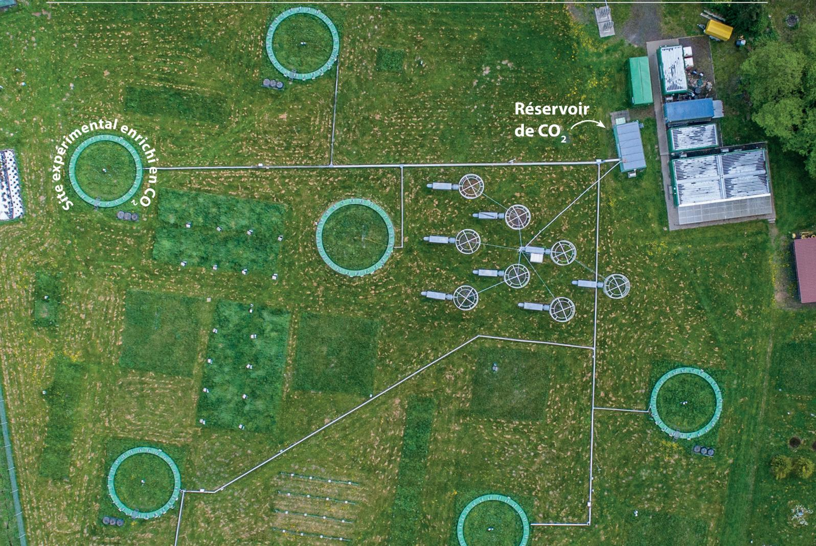
**L'expérience d'enrichissement en CO<sub>2</sub> menée à l'air libre (FACE) consiste à pomper de l'air enrichi en CO<sub>2</sub> sur plusieurs sites expérimentaux constitués de tuyaux disposés en cercle, afin de simuler les quantités de CO<sub>2</sub> que devrait contenir l'atmosphère au milieu du siècle et d'en apprécier les retombées sur des pâturages typiques.**
