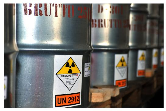
Le concentré d'uranium est stocké dans des fûts en acier spécialement conçus, hermétiquement fermés, de la taille de barils de pétrole. Plein, chacun de ces fûts ne pèse pas plus de 350 kilogrammes.
