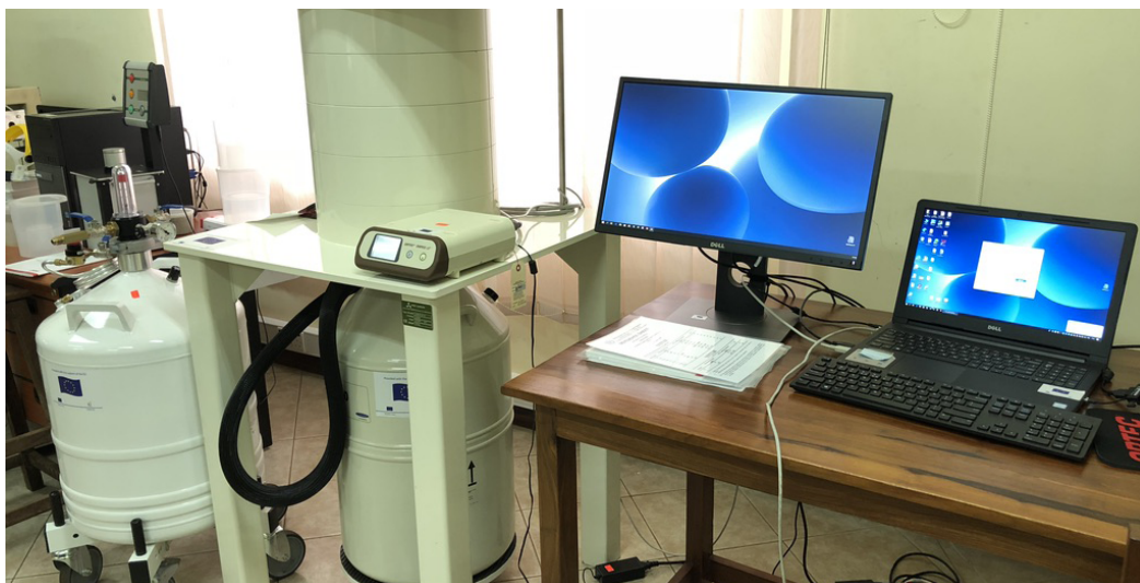
铀实验室设备包括一个伽马能谱系统，用于帮助当局对该国发现的铀进行适当评估。 (图/坦桑尼亚原子能委员会D. Mwalongo)
