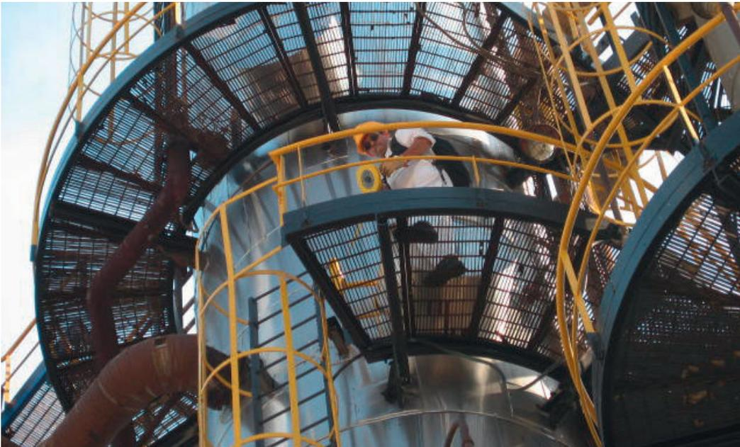
Специалист CNESTEN по гамма-сканированию проводит инспекцию 75-метровой вакуумной насадочной дистилляционной колонны на нефтеперегонном заводе в Марокко.
