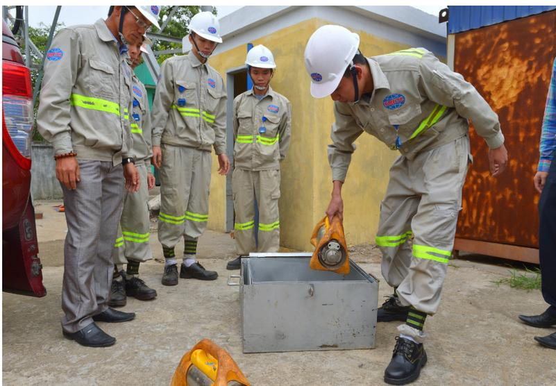
7 Pour tester le système de suivi des sources radioactives, des collègues coréens et vietnamiens ont réalisé des essais sur le terrain afin de vérifier la fonctionnalité du système de suivi dans différentes conditions de fonctionnement. Ces essais permettent de s'assurer que le titulaire de licence et l'organisme de réglementation connaissent bien leurs rôles et responsabilités respectifs et qu'une fois déployé, le système fera gagner un niveau de sécurité.
