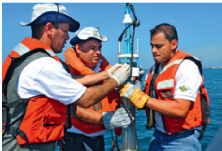
Un grupo de científicos sumerge un equipo de obtención de muestras testigo de sedimentos frente a las costas de Honduras, en 2009, para estudiar los efectos de la contaminación del agua mediante técnicas nucleares.
