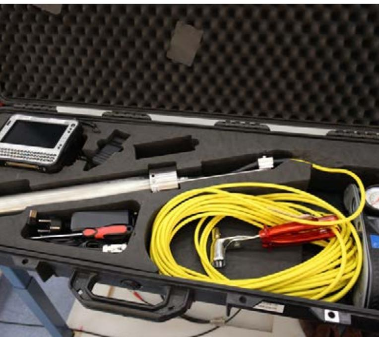
Por ejemplo, el **dispositivo de análisis de atributos del combustible irradiado** consta de un pequeño detector de rayos gamma sensible (del tamaño de una gema pequeña), insertado en un tubo protector que se sumerge en la piscina de combustible gastado para medir los elementos ahí almacenados. El detector está conectado por medio de cables a un analizador situado junto a la piscina de combustible.
