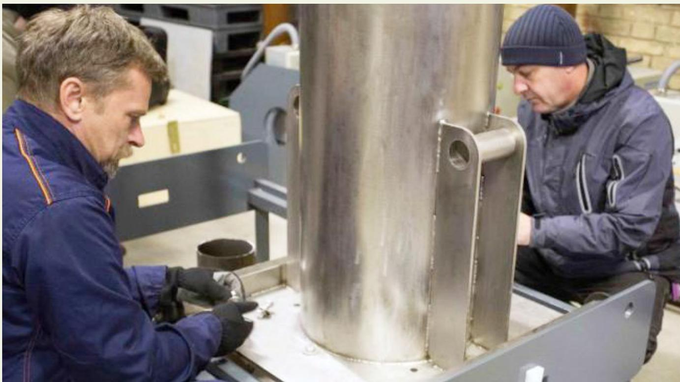
**Des ingénieurs de l'AIEA et une société croate de radioprotection mettent à l'essai un nouveau système permettant de stocker définitivement, de manière sûre et sécurisée, des sources de faible radioactivité dans des puits.** [Photo: L. Gil (AIEA)]
