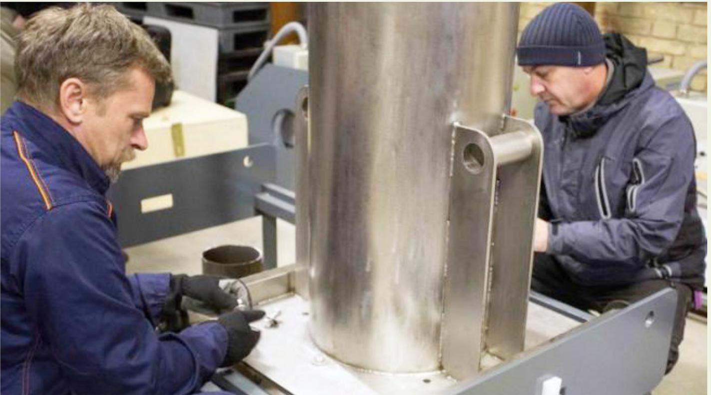
**Ingenieros del OIEA y una empresa croata de protección radiológica prueban un nuevo sistema de disposición final segura de fuentes de baja actividad en pozos barrenados.** (Fotografía: L. Gil, OIEA)
