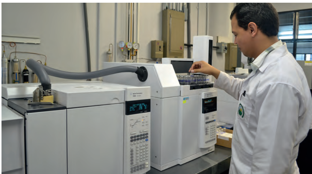
Análisis de muestras tomadas sobre el terreno con un cromatógrafo de gases con cargador de muestras automático y cámara volátil.
