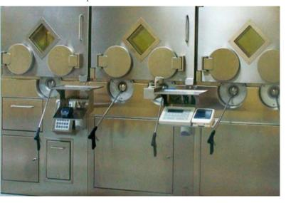
Las celdas calientes de la instalación para la producción de radiofármacos basados en Y 90 establecida recientemente se ajustan a las buenas prácticas de manufactura a fin de proteger a los trabajadores y garantizar la producción de fármacos de gran calidad.
