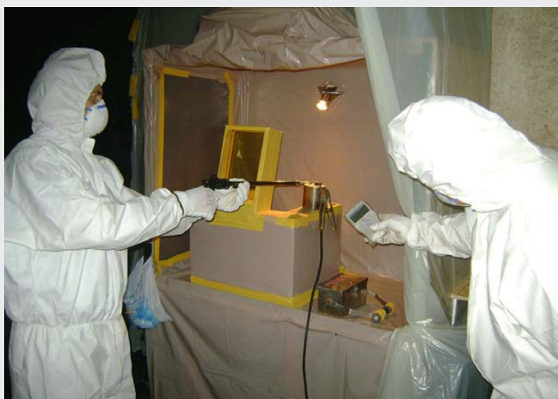
Vérification du niveau de radioactivité d'une capsule contenant des sources au césium 137 conditionnées. (Photo : J. Balla/AIEA)
