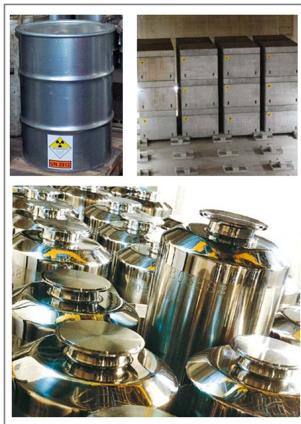
À partir du haut à gauche : Fût en acier de 200 litres, caissons en béton et conteneurs en acier inoxydable pour déchets de haute activité (DHA)
