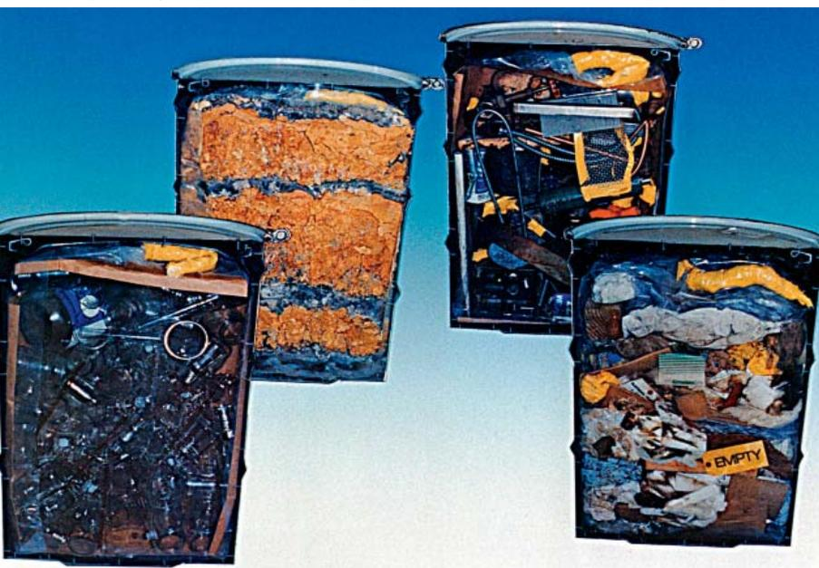
Технологический процесс прессования под высоким давлением позволяет уменьшить высоту 200-литрового контейнера до менее чем 10 см
