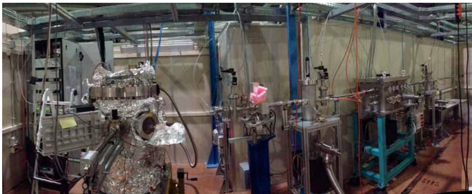
6 在国际原子能机构位于意大利的里雅斯特Elettra同步加速器室的束线全景图。同步加速辐射束线从室的右侧进入，最终到达超高真空室，即在中心左边看到的终端站。同步回旋加速器束光设施产生X射线，其亮度是医用X射线的数百万倍。科学家利用这些高度聚焦的强X射线束揭示金属、半导体、陶瓷、聚合物、催化剂、塑料和生物分子等各种材料中的原子特性和安排。国际原子能机构束线自2014年4月以来一直在工作。该束线尤其适合于材料科学应用。
