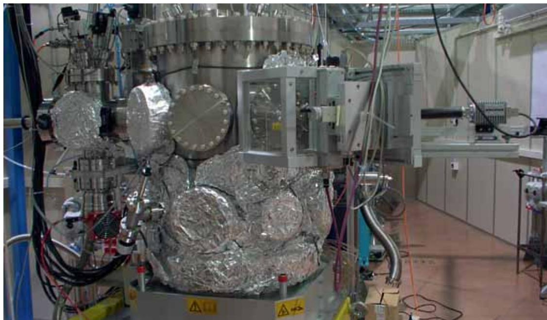
1 设在意大利的里雅斯特Elettra同步回旋加速器的原子能机构新的束线超高真室终端站。这种最新X射线荧光束线可用于分析材料中的化学元素。该先进技术的成果之一是能够制作正在测试材料的化学分析的二维和三维图。该机器已从柏林运到的里雅斯特，目前正在调试中，2014年7月前可供成员国使用。
