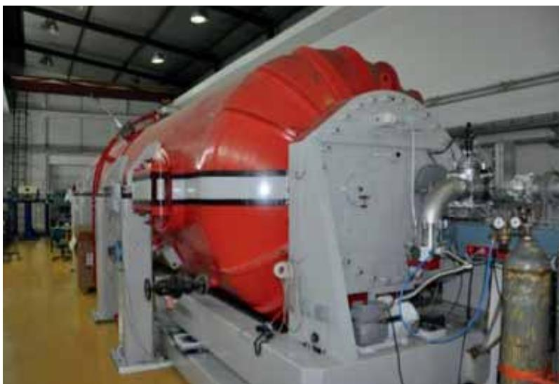
7 国位于克罗地亚萨格勒布杰·博斯科维奇研究所的离子束加速器。原子能机构核科学和仪器仪表实验室自1996年以来一直在这个加速器运行一个束线。该加速器利用600万伏电压对用于各种应用（例如材料分析）的质子进行加速。
