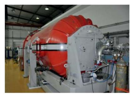
7 Ускоритель ионного пучка в Институте им. Руджера Бошковича (ИРБ) в Загребе, Хорватия. ЛЯНП МАГАТЭ занимается эксплуатацией тракта пучка на этом ускорителе с 1996 года. Ускоритель использует напряжение в шесть миллионов вольт для ускорения протонов, которые используются для широкого спектра применений, например, для анализа материалов. (Фото: Институт им. Руджера Бошковича, Загреб)
