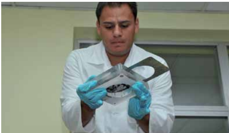
12 Подготовка проб для анализа – это сложный процесс, включающий выполнение различных операций. На фотографии: д-р Деннис Каналес-Крус, руководитель гондурасской группы специалистов по проекту, осторожно извлекает из вертикального керна срез пробы отложений.
