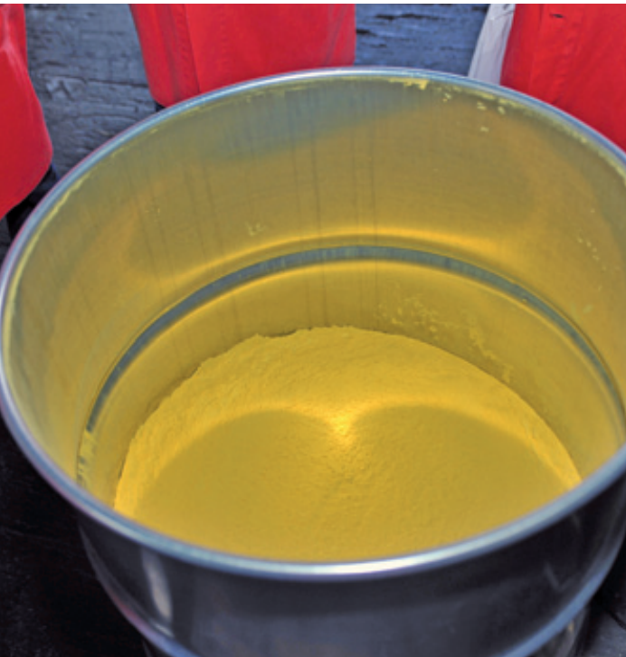
5 Le minerai d'uranium est transformé en un concentré dit « yellowcake », qui est produit à quelques kilomètres de la mine.
