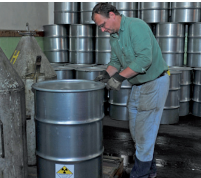
7 Le concentré uranifère est emballé dans des fûts d'acier spéciaux, hermétiquement scellés d'une taille semblable à celle des barils de pétrole. Chacun ne pèse pas plus de 350 kg une fois plein.
