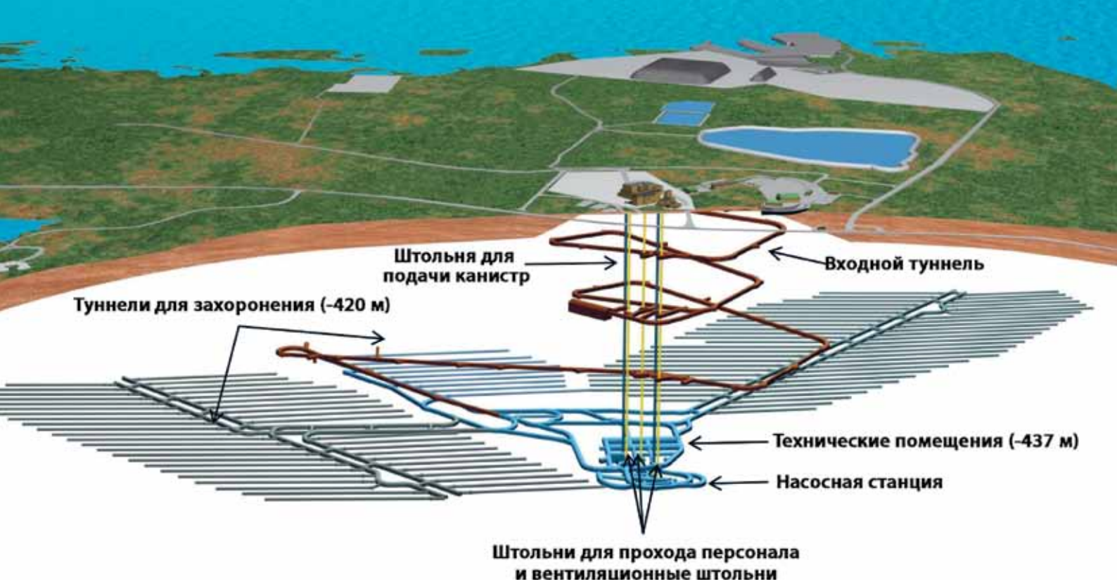
Рисунок установки для окончательного захоронения ядерных отходов высокой активности. (Предоставлен: компанией "Посива Ой")
