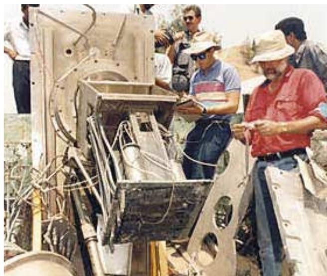
Инспекторы осматривают остатки оборудования электромагнитного разделения изотопов (ЭМРИ), извлеченные из разрушенного при бомбардировке здания в Ираке.
