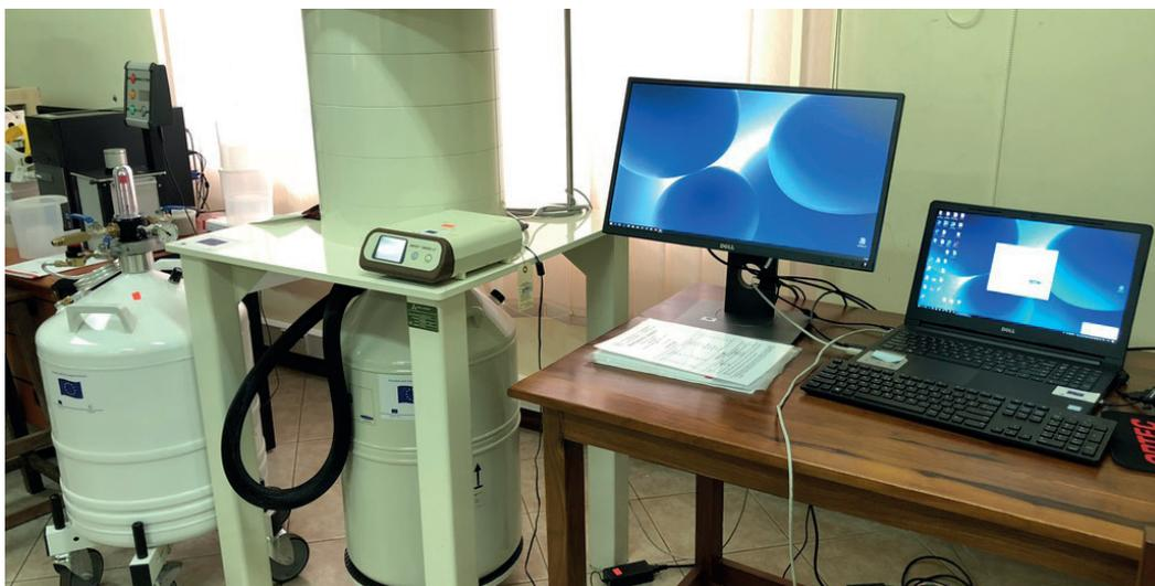
**Урановая лаборатория оснащена, помимо прочего, системой гамма-спектрометрии, с помощью которой власти смогут проводить надлежащую оценку урана, добытого в стране.**
