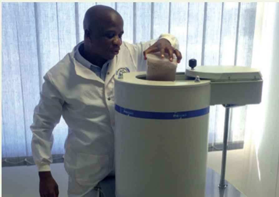
Un spectromètre gamma, don de l'AIEA, est utilisé pour mesurer les rayonnements naturels au Botswana.
