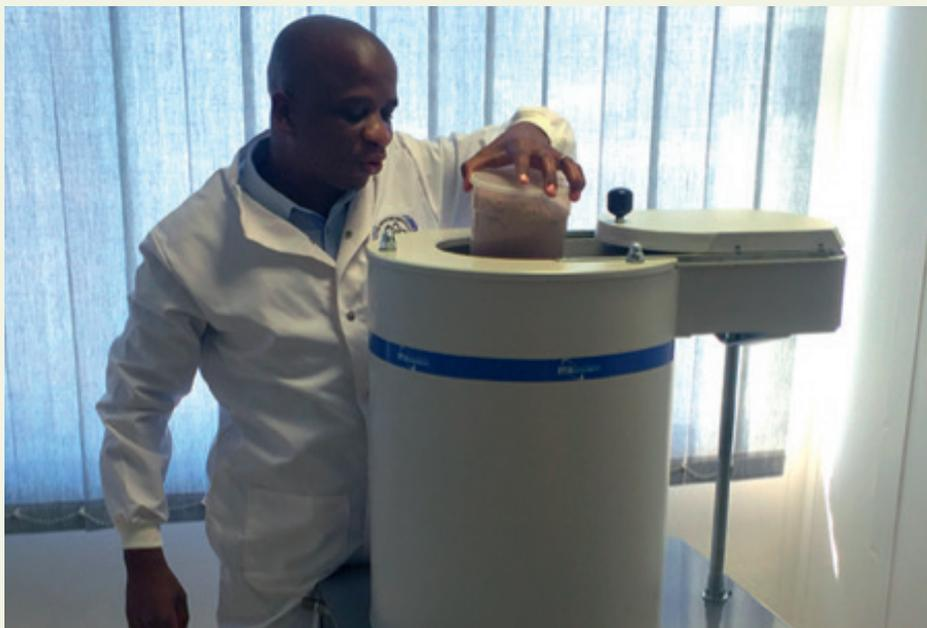
**Un espectrómetro de rayos gamma donado por el OIEA es utilizado para medir la radiación natural en Botswana.**
