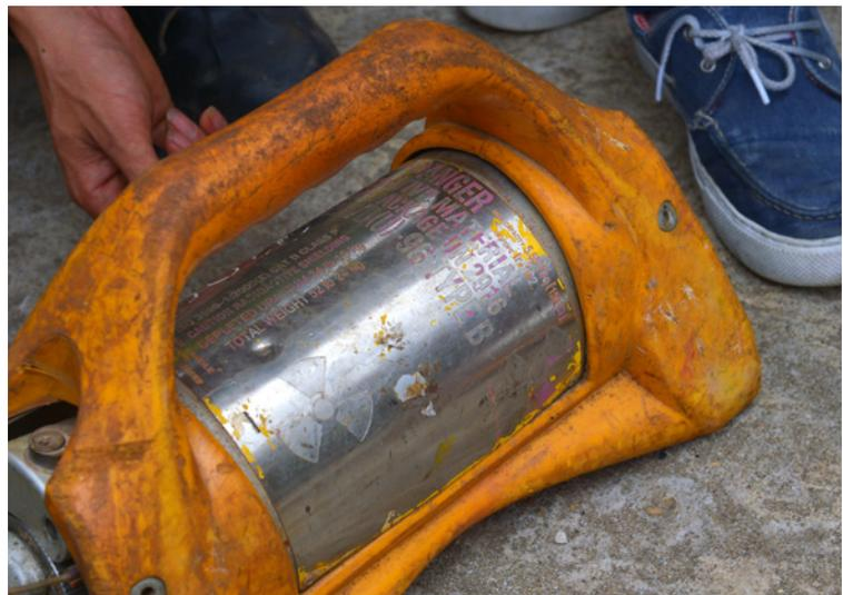
**2** Del mismo modo que los rayos X se utilizan para detectar fisuras en los huesos, los aparatos de radiografía industrial se utilizan para detectar grietas o imperfecciones en los componentes industriales. Esos dispositivos contienen fuentes radiactivas y son portátiles, lo que hace que puedan perderse o ser objeto de robo. Todos los años se notifican al OIEA casos de pérdida o robo de fuentes radiactivas.
