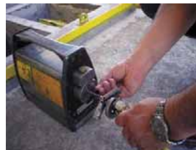
Типовое устройство для защиты источника на основе иридия-192.
