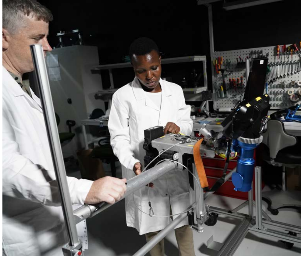
مفتشو الضمانات يستعدون لاستخدام جهاز رؤية ظاهرة تشيرينكوف (جهاز XCVD)
