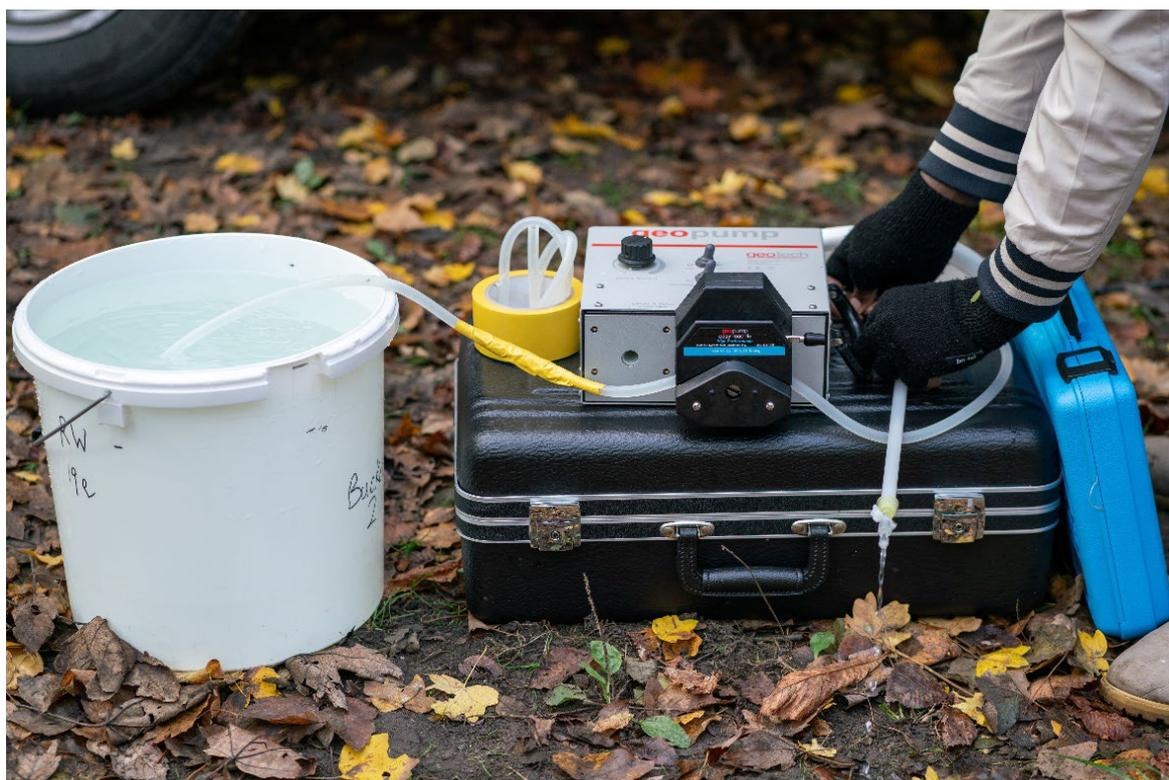
*FIG. L.2. Collecte et concentration du soufre 35 dans des échantillons d'eaux souterraines sur le terrain à l'aide de colonnes de résine portables. (Photo : AIEA)*
