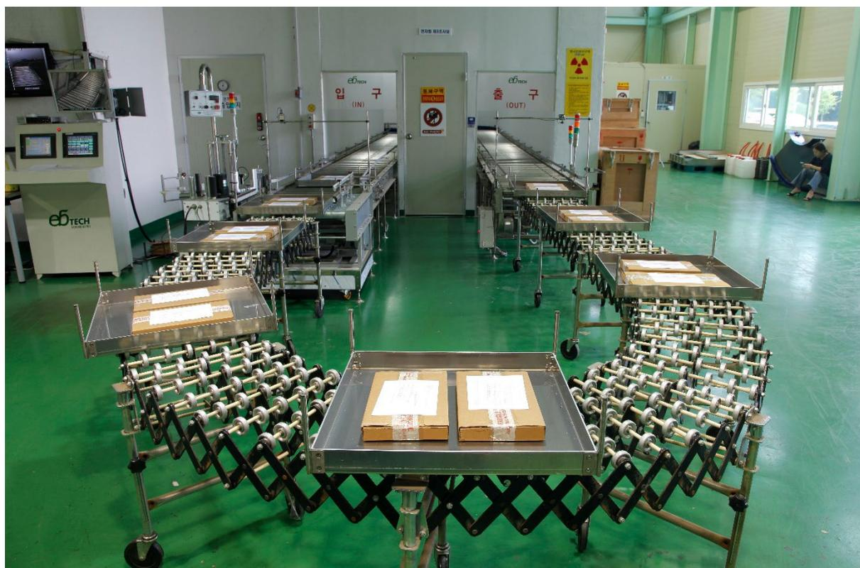
*FIG. K.3. Les faisceaux d'électrons sont actuellement utilisés à des fins industrielles dans 40 États Membres. Ici, irradiation de semi-conducteurs par un faisceau d'électrons de 10 MeV (20 kW) dans une entreprise privée de Daejeon (République de Corée). (Source : AIEA)*
