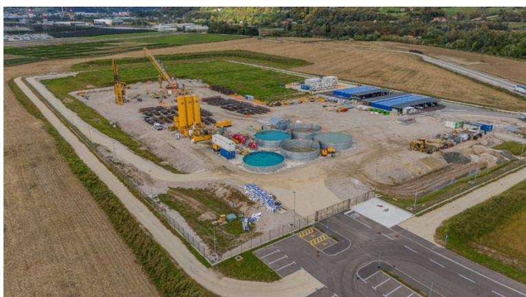
*FIG. C.4. En Slovénie, la construction de l'installation de stockage définitif des déchets de faible activité a commencé. (Source : ARAO)*
