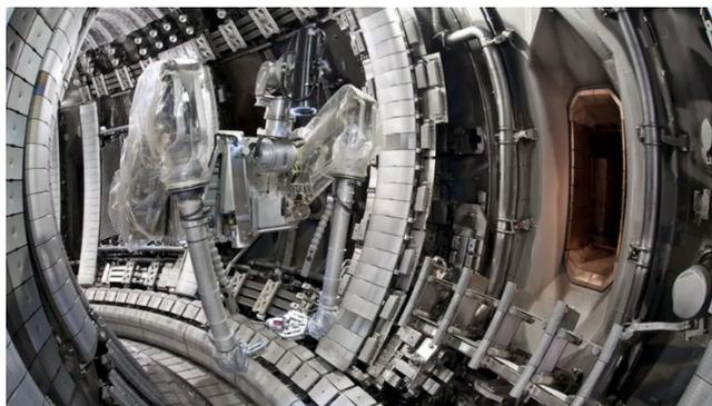
*FIG. D.2. La réaffectation du JET sera facilitée par des systèmes de télémanipulation.
