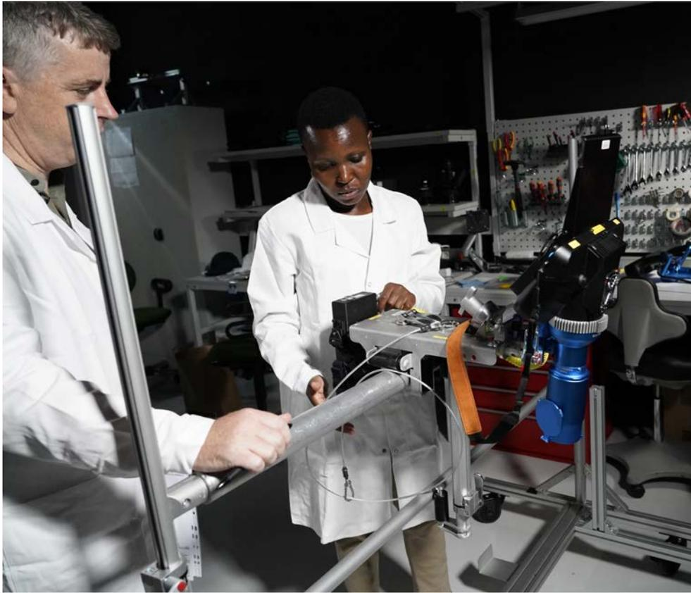
Inspectores de salvaguardias se preparan para usar el dispositivo de observación de la radiación Cherenkov de próxima generación (XCVD).
