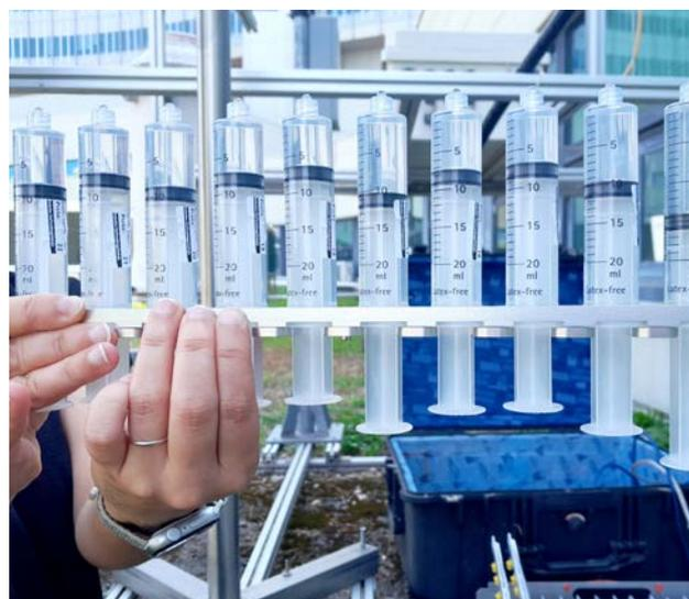
Un experto del Organismo prueba el diseño de sistemas de muestreo automatizados para fenómenos pluviométricos extremos.
