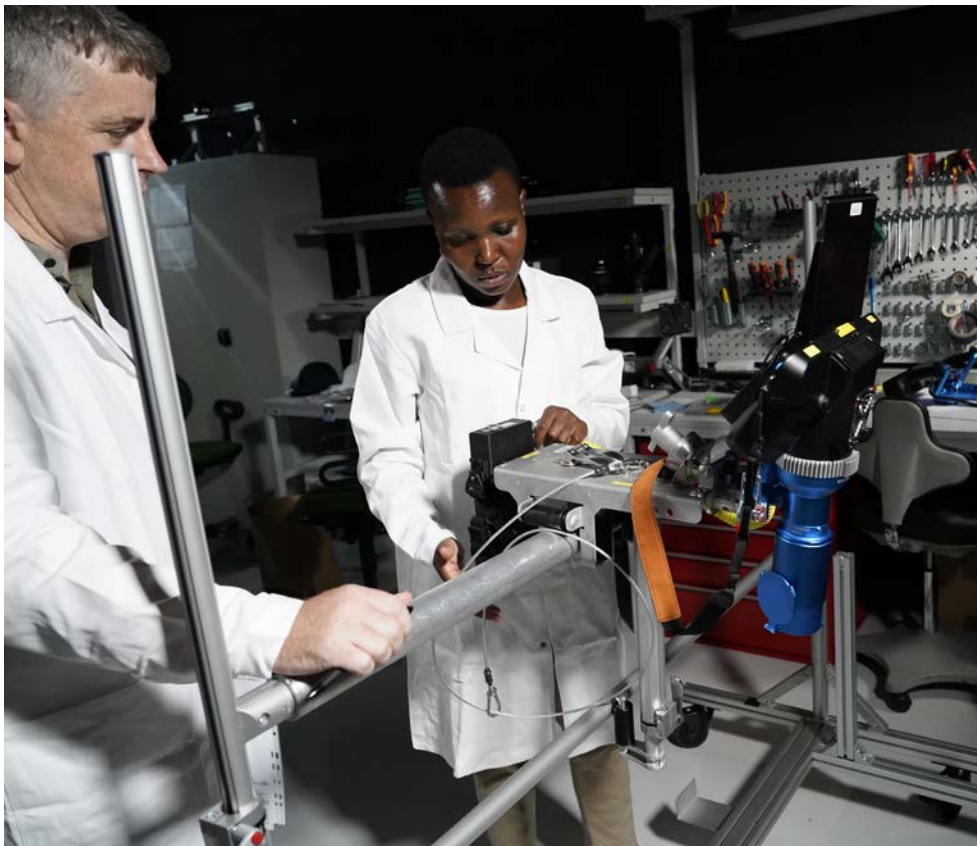
Инспекторы по гарантиям готовятся к работе с устройством для наблюдения излучения Черенкова нового поколения (XCVD).
