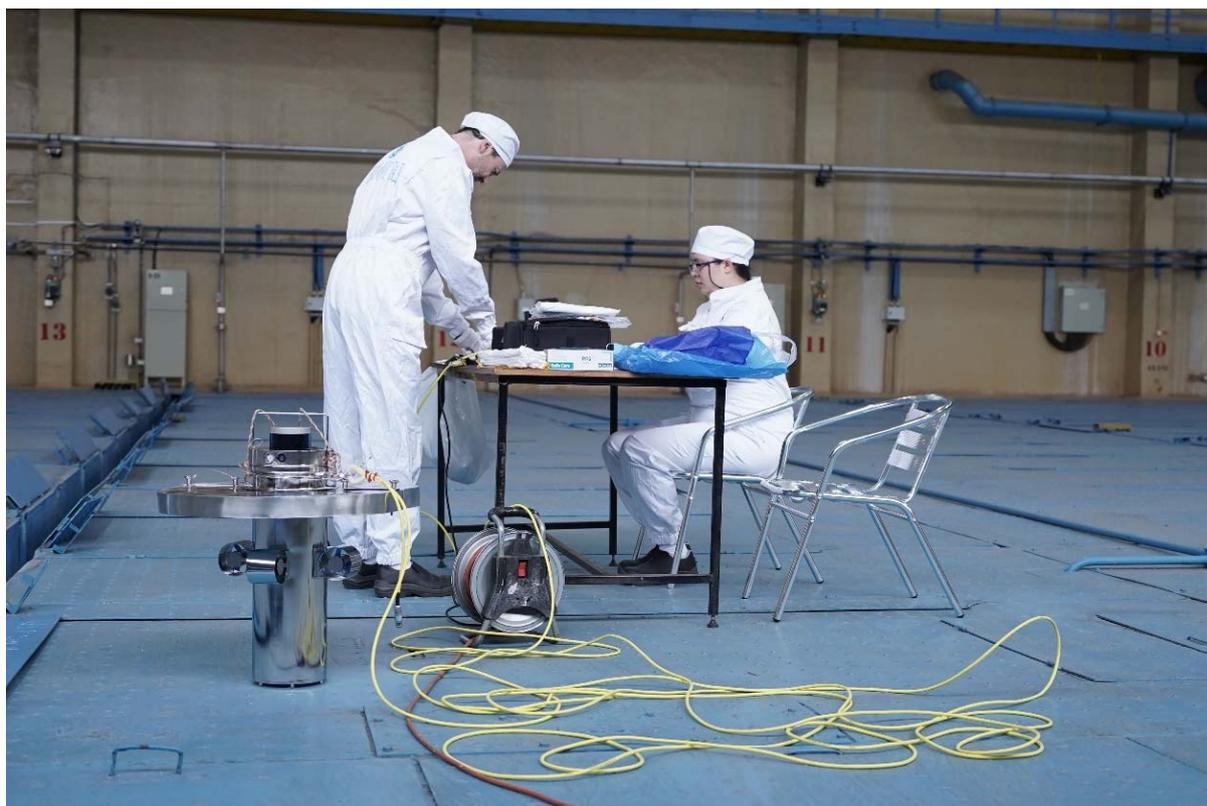
*Personal de salvaguardias despliega un dispositivo de observación de la radiación Cherenkov robotizado (RCVD). (Fotografía: OIEA)*
