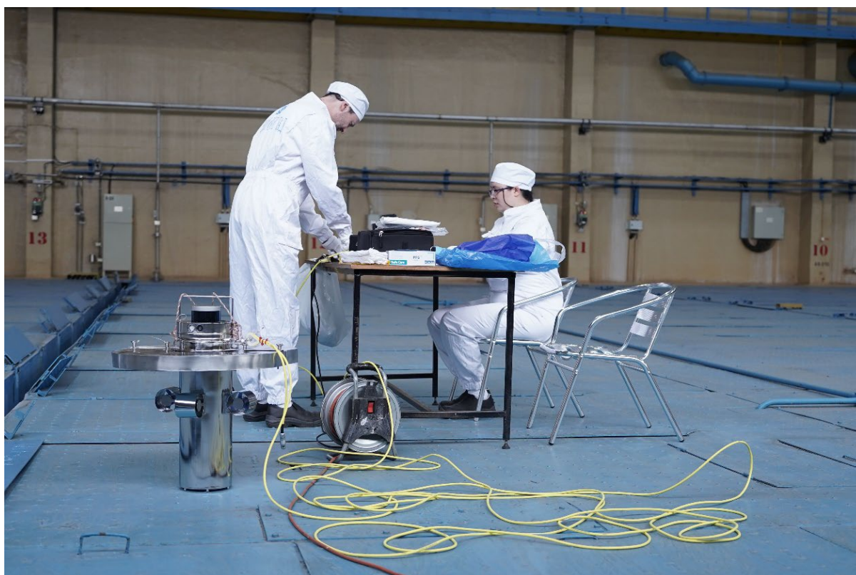
Специалисты по гарантиям работают с роботизированным устройством наблюдения излучения Черенкова (RCVD) (Фото: МАГАТЭ)
