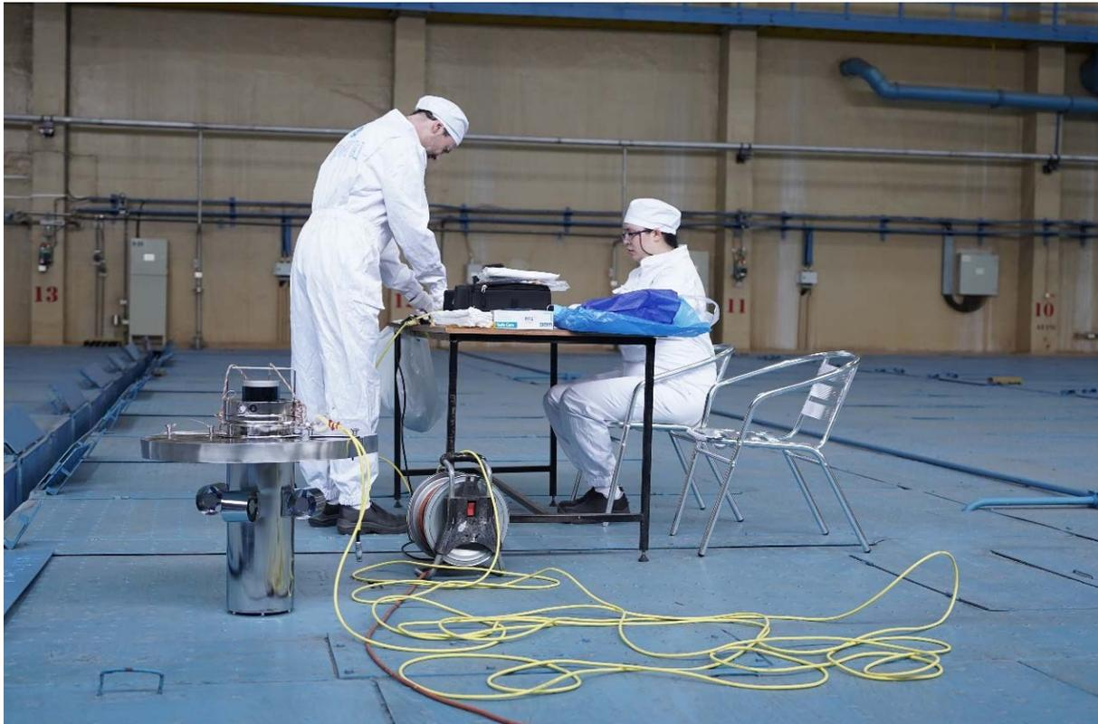
保障工作人员部署自动化的切伦科夫观察装置（照片来源：原子能机构）
