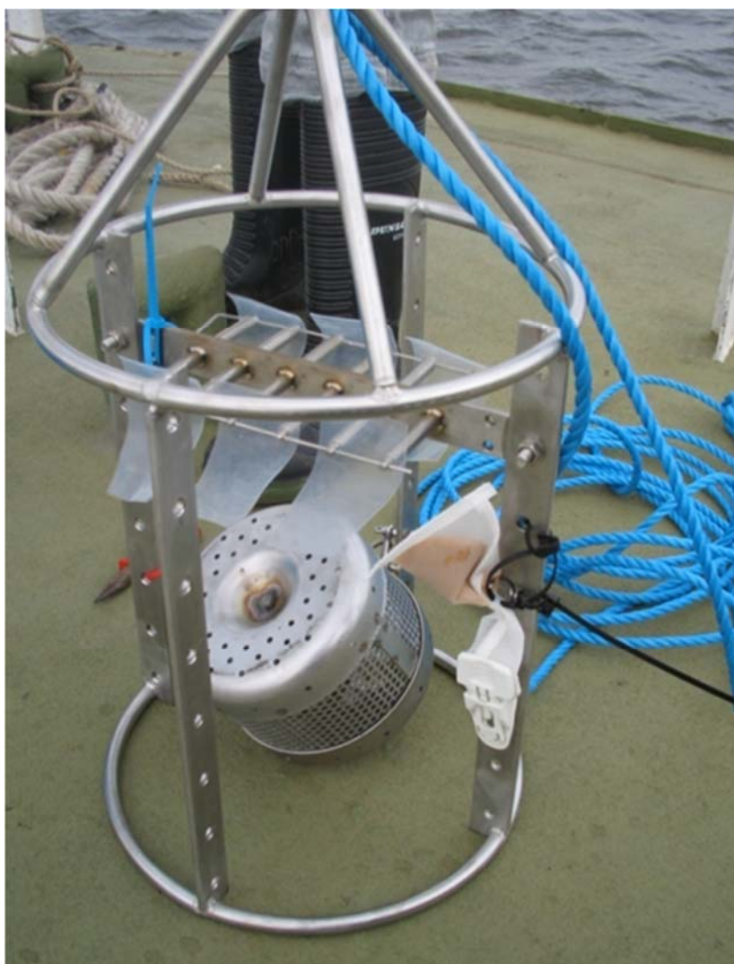
FIG. I.2. Dispositifs d'échantillonnage passif prêts à être installés en mer. (Photo : Centre for Environment, Fisheries and Aquaculture Science, Royaume-Uni)
