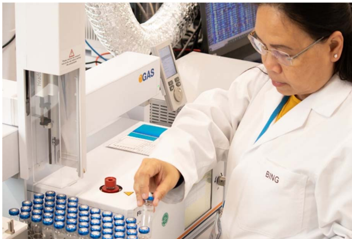
FIG. F.3. Analyse menée par GC-IMS dans l'espace de tête pour détecter les traces caractéristiques de contaminants alimentaires au Laboratoire du contrôle et de la sécurité sanitaire des aliments du Centre mixte FAO/AIEA des techniques nucléaires dans l'alimentation et l'agriculture, à Seibersdorf (Autriche). (Photo : AIEA)
