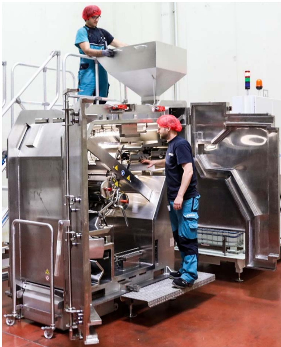
FIG. F.5. Matériel de traitement des aliments émettant des électrons de faible énergie. La technologie Laatu utilise deux lampes à électrons de faible énergie (poignées rouges au centre de l'image) pour traiter les ingrédients séchés en les faisant tomber dans un flux d'électrons. Capable de réduire la consommation d'énergie jusqu'à 80 % par rapport à la stérilisation à la vapeur, elle propose une solution rentable de réduction de la charge microbienne. (Photo : Bühler)
