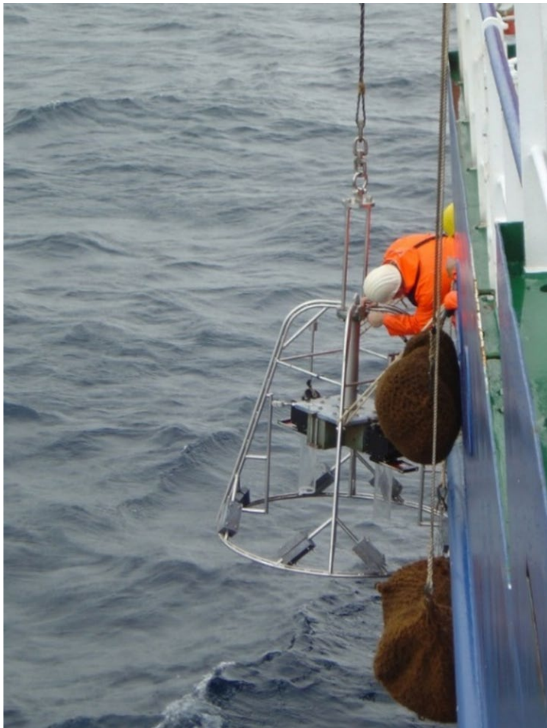
图 I.4. 正在部署一个多功能取样器, 收集未受扰动的沉积物样品, 以分析污染物和气候变化迹象。沉积物保存了年代信息, 放射性示踪剂将被用于确定这些自然档案中记录的过去事件的日期。(照片来源: 原子能机构)
