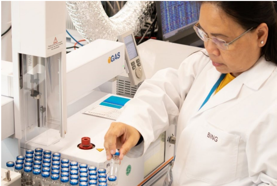
图 F.3. 在奥地利塞伯斯多夫粮农组织/原子能机构粮农核技术联合中心的食品安全和控制实验室进行顶空气相色谱法-离子迁移谱法分析，检测食品污染物的特征指纹。（照片来源：原子能机构）
