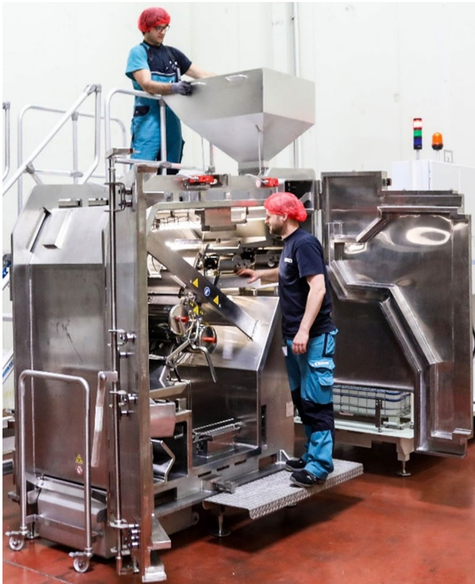
图 F.5. 软电子食品加工设备。Laatu 机器使用两个低能电子灯（图片中间的红色把手），在干燥成份从电子流飘落的过程中，对其进行加工。与蒸汽法相比，它的能耗降低了高达 80%，提供了一种具有成本效益的微生物还原方案。（照片来源：布勒）
