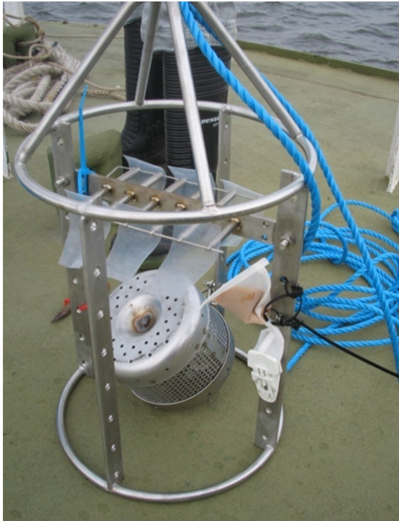
图 I.2. 准备在海上部署的被动采样装置。 (照片来源：英国环境、渔业和水产养殖科学中心)
