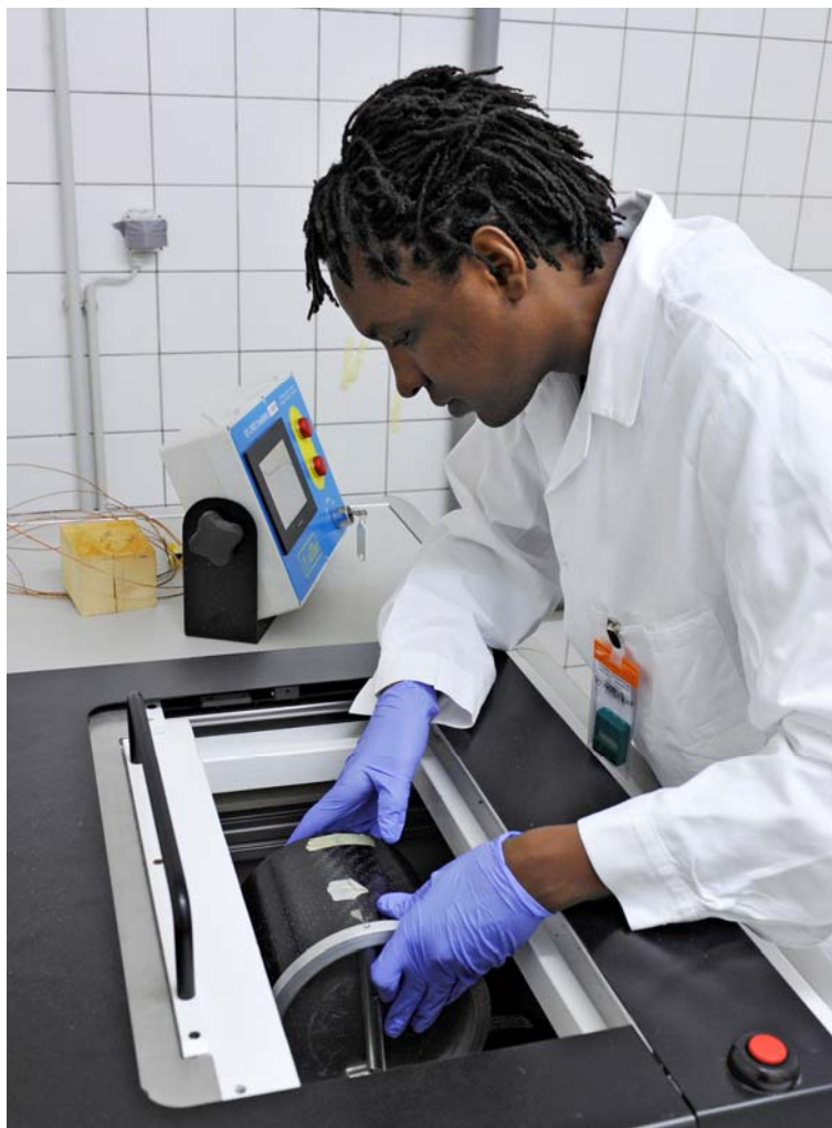
Un chercheur de l'Agence se sert d'un appareil à rayons X pour irradier des organismes de plus grande taille à des doses plus faibles.
