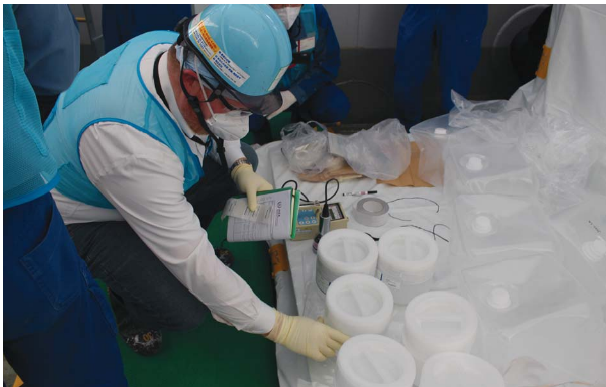
Un expert de l'Agence assure la gestion des échantillons d'eau traitée par le système ALPS qui ont été prélevés à la centrale nucléaire de Fukushima Daiichi et qui seront ensuite analysés par l'Agence et des laboratoires tiers. (Crédit photo : TEPCO)
